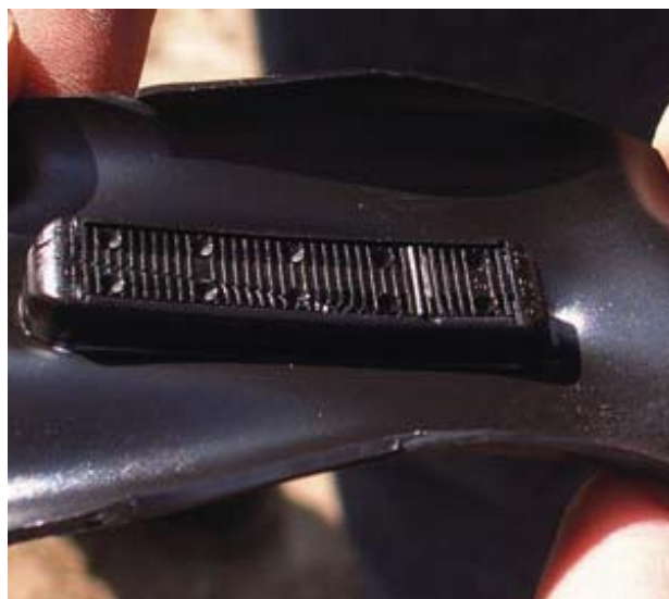
Detalle del laberinto interior de un gotero utilizado en riego subterráneo.
