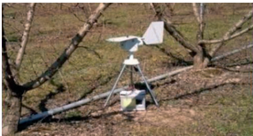
Figura 6: Captador de esporas funcionando en un huerto de melocotones en el Valle del Ebro.
