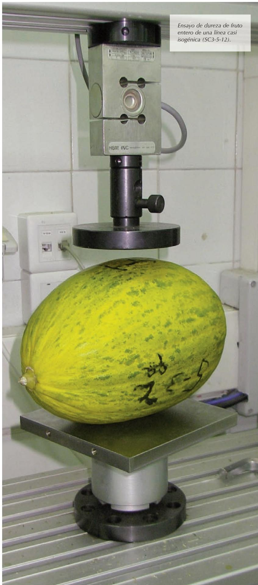
Ensayo de dureza de fruto entero de una línea casi isogénica (SC3-5-12).
