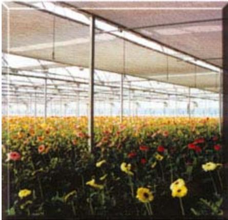
Gracias a la aplicación de aluminio, las pantallas térmicas Ulma permiten obtener un nivel óptimo de reflexión de los rayos solares, lo que equivale a un nivel idóneo de refrigeración del cultivo. Este mismo aluminio efectúa una óptima reflexión del calor, lo que en temporadas frías supone un ahorro considerable de energía.
