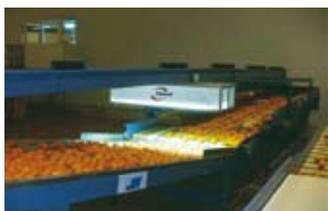
**El sistema de visión artificial de Citrosol que permite homogeneizar con mucha precisión el recubrimiento céreo de todos los frutos.**
