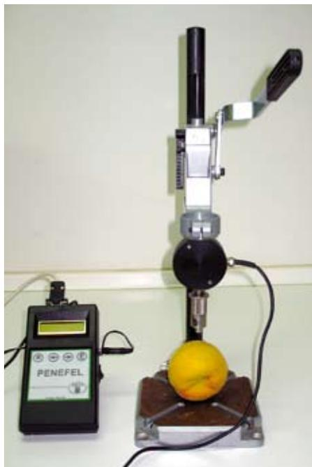
**Medición de la firmeza de la pulpa de muestras del ensayo de riego deficitario controlado en la variedad 'Calrico' futuro clon autorizado por la DO 'Melocotón de Calanda'.**
