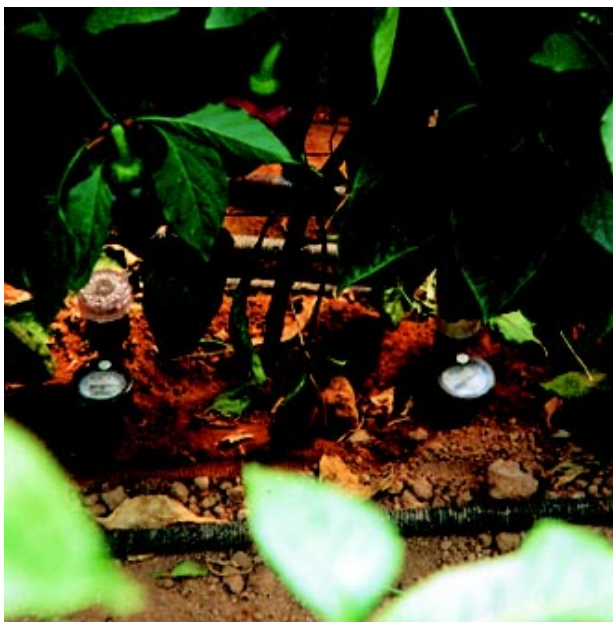
Control de la nutrición hídrica mediante tensiómetros de una plantación de pimiento en suelo con calefacción
