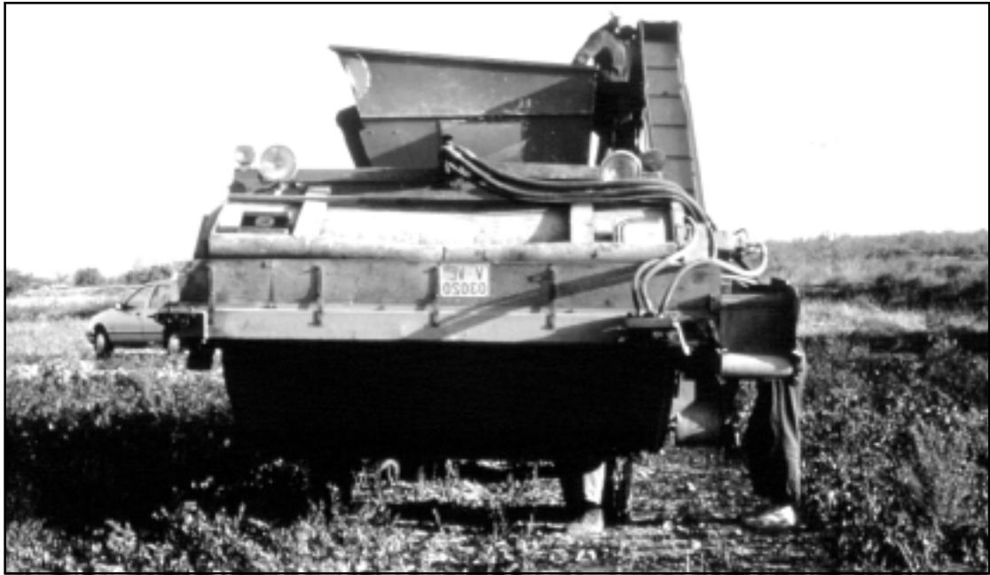
Cosechadora de judías verdes FMC, con dedos del rotor arrancador modificados, ensayada en Lorca
