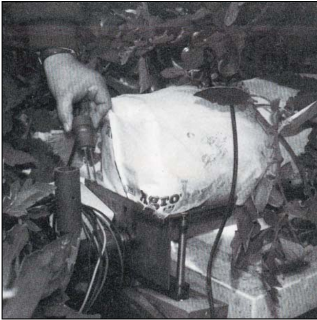
Bandeja de drenaje conectada al ordenador para regar a la demanda.
