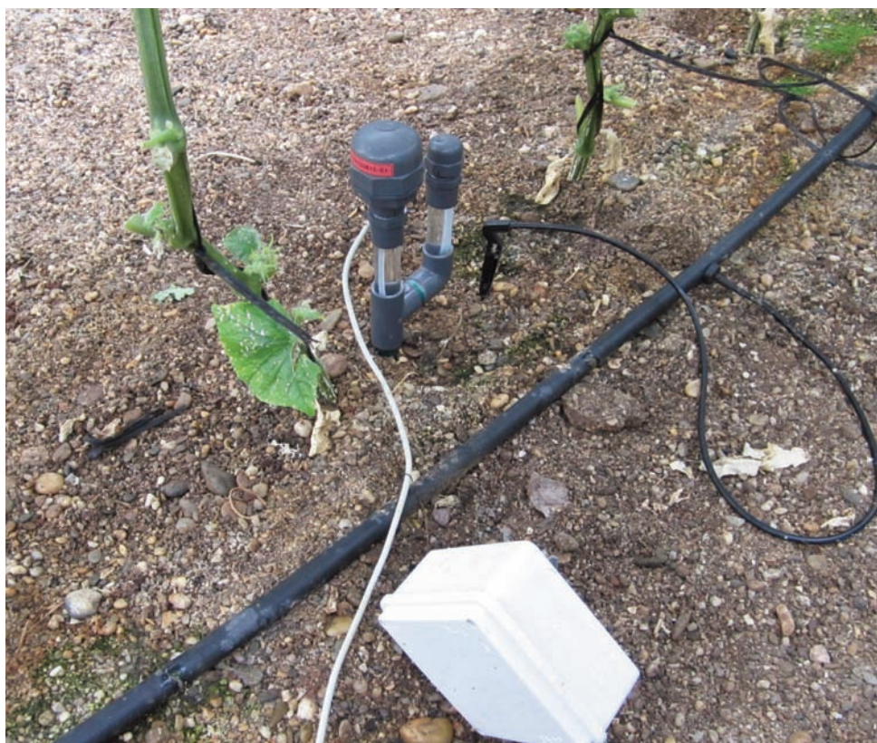
Los sensores miden cada 5 minutos las variables tradicionales de la agricultura: pH, conductividad, nitratos, temperatura, etc.
