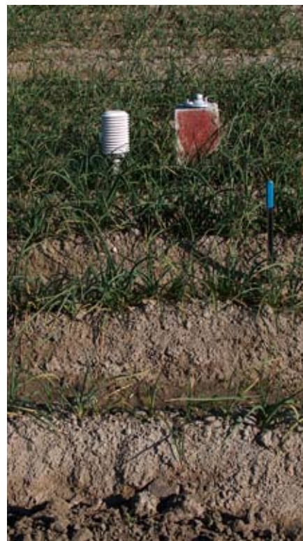
Sondas de medida en el campo de ensayos
