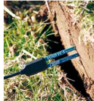
Izda. Vista del campo de ensayo. Centro. Nodo repetidor y nodo sensor de la red inalámbrica ZigBee. Dcha. Sensor capacitivo EC-5 para medir la humedad del suelo
