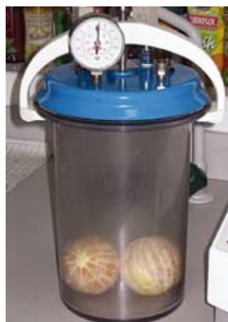
Oxímetro y cámara estanca para determinar la tasa respiratoria.
