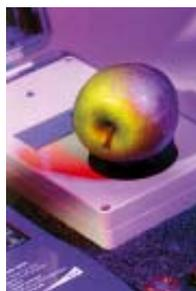
dores electromagnéticos para producir la excitación en las muestras, y acelerómetros miniatura para adquirir las correspondientes respuestas. Se mantuvo básicamente el estudio de las frecuencias resonantes como indicadores de las características de firmeza de los productos, y el correspondiente coeficiente de rigidez.
