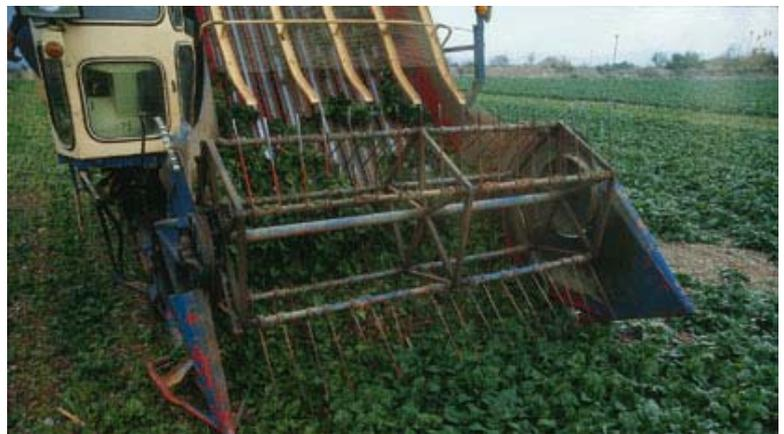
Estas cosechadoras montan motores de unos 80 kW, transmisiones mecánicas con ocho velocidades, miden unos 7 m de longitud por 2.5 de ancho, su masa en vacío es de 4-5 mil kilogramos y la capacidad de carga de unos 3000 kg.
