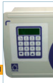
El Mithra Clima 2004, destaca por su capacidad para controlar entre 2, 4 y 6 compartimentos climáticos
