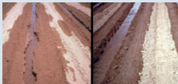
SoilFix estabilizador de suelos es un polímero soluble, con alto peso molecular. En la imagen se aprecia la diferencia entre un suelo sin tratar (izquierda) y otro con Soilfix (derecha).
