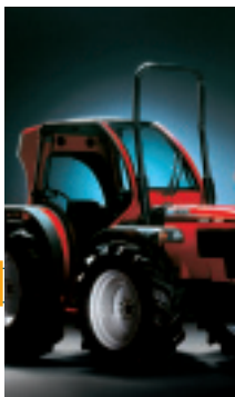
Cabina "Protector Cougar" de Antonio Carraro que se complementa con el equipo de pre-surización que evita la entrada de emisiones químicas.
